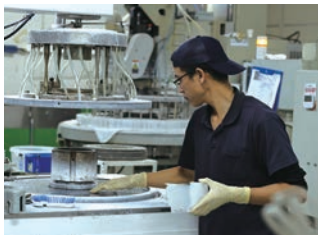
ポリッシング加工は微細な砥粒と軟質なパットを用いて加工を行う。
